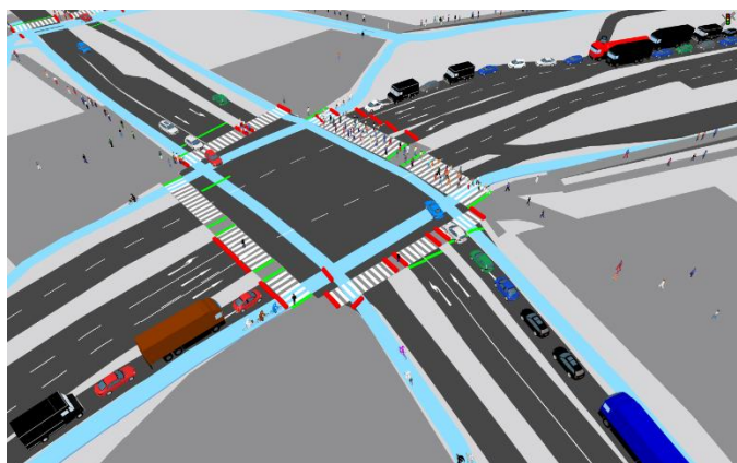
Figur 30 Store kødannelser for motor køretøjer i krydset ved Havneholmen i alle scenarier, hvilket er uafhængigt af
