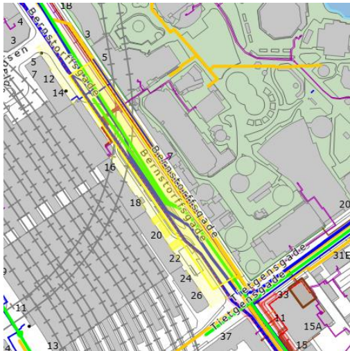
Billede 5: Eksisterende ledninger v. kommende stationsboks i Bernstorffsgade. Signaturforklaring: M5 station Gul // Blå Vand// Grøn Spildevand//Lilla Fjernvarme//Rød Fjernkøl//Orange Gas
