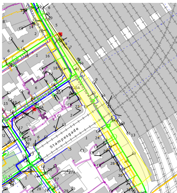
Billede 3: Eksisterende ledninger v. kommende stationsboks i Reventlowsgade. Signaturforklaring: Gul M5 station// Blå Vand// Grøn Spildevand// Lilla Fjernvarme// Orange Gas
