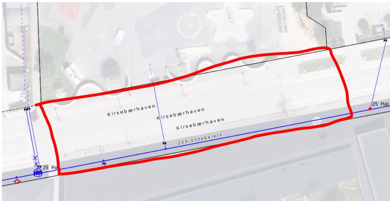
Kort 2: HOFOR Vand København A/S' vandforsyningsledning 200 Støbejern med vandstikledning 75 Støbejern.
