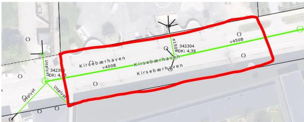
Kort 2: HOFOR Vand København A/S' vandforsyningsledning 200 Støbejern med vandstikledning 75 Støbejern.
