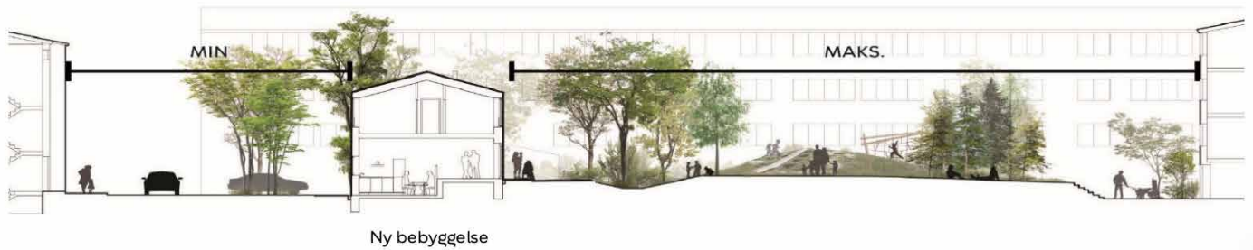
Princip for udstrækning af hhv. haverum og gader ved placering af nye rækkehuse langs vejene. Princippet er, at der er minimal udstrækning af vejareal og maksimalt bevaret haverum. Illustration: SLA og Vandkunsten.
