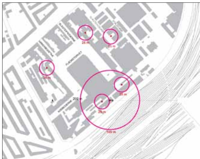
Risikozoner med angivet sikkerhedsafstand fra kødanlæg og nødventilatorer
