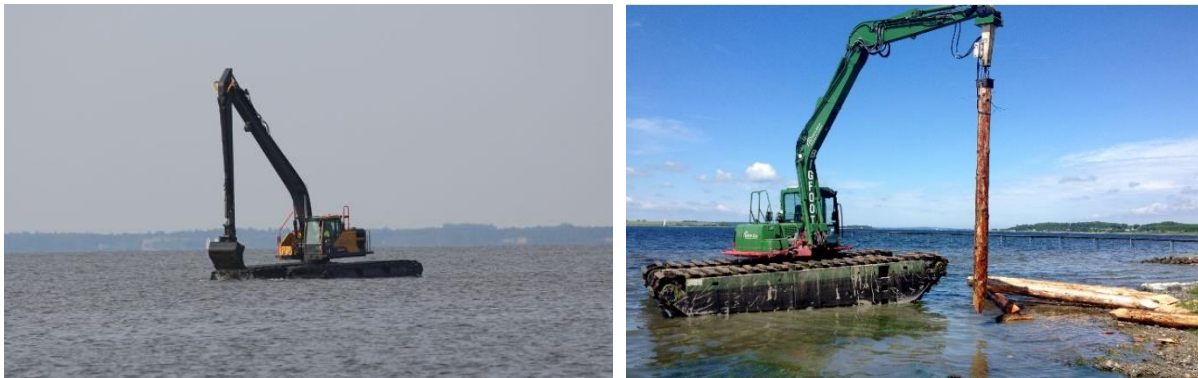
Figur 18: Eksempler på amfibiemaskiner fra NNE A/S (til venstre) og Entreflex A/S (til højre).
