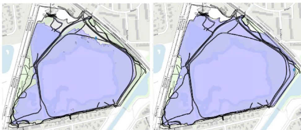
Figur 3-16 10-årshændelse i år 2050, Volumen 86.000, vandstand 9,63 m. og 100-årshændelse i år 2100, Volumen 320.000, vandstand 11,00 m.
