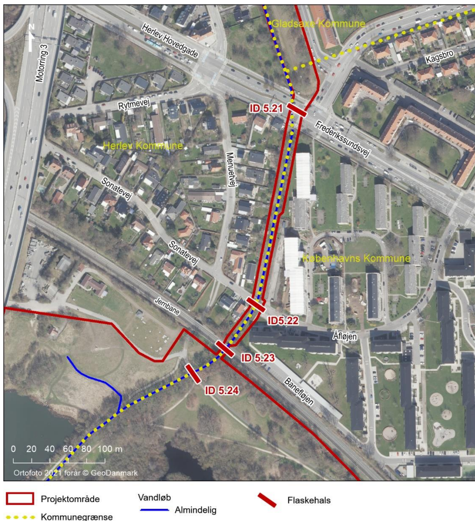
Figur 3-10 Eksisterende flaskehalse i Nedre Kagså. Herlev Hovedgade (ID 5.21). Sonatevej (gang/cykelbro) (ID 5.22). Jernbanebro. (ID 5.23) Stibro (gang/cykelbro) (ID 5.24). Kommunegrænserne er indtegnet.
