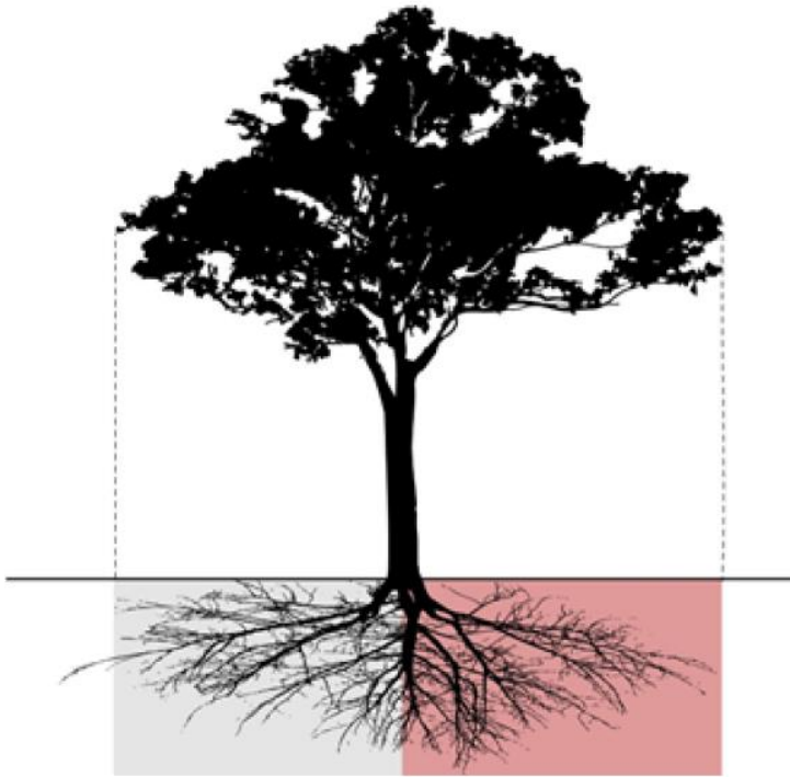
Figur 3-5. Principskitse for påvirkning af træ, der medfører at det ryddes. Drypzone svarer til kronens radius, og hvis den påvirkes i mere end 50% af dens udstrækning, vurderes det, at træet ikke kan overleve.
