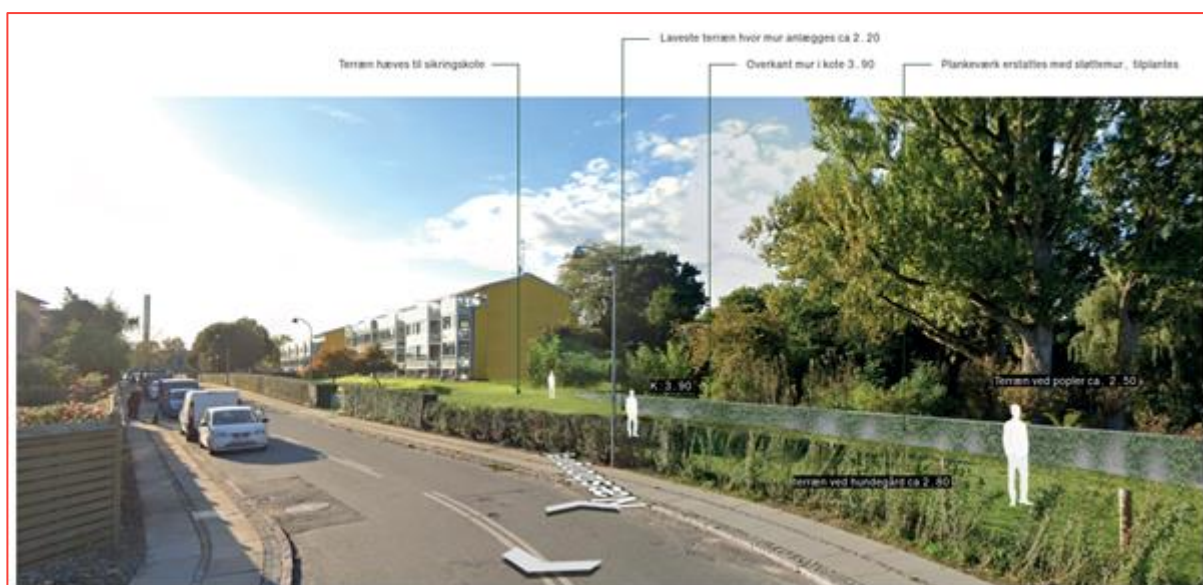
Figur 3-20 Foreslået princip for højvandssikringen langs Næsborgvej.
