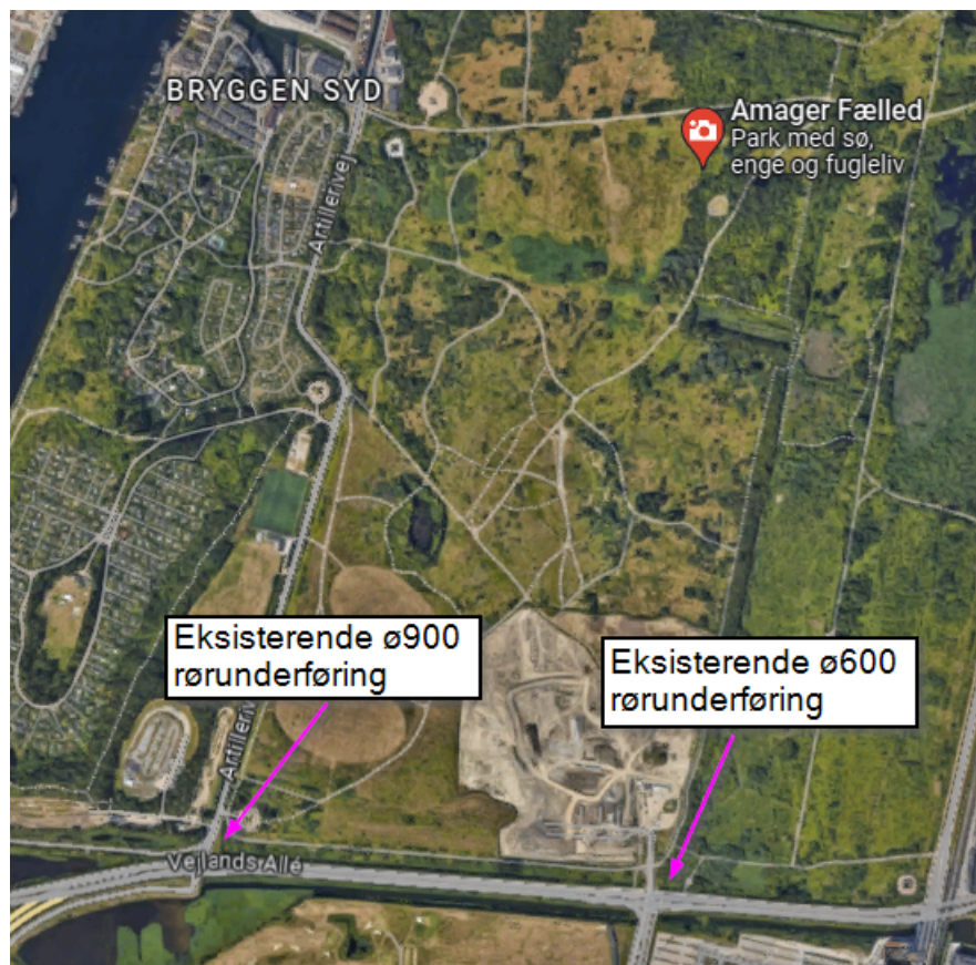
Figur 1: Kort over eksisterende rørlægning af Hovedgrøften Syd (ø600 under adgangsvejen og ø900 ved Artillerivej).
