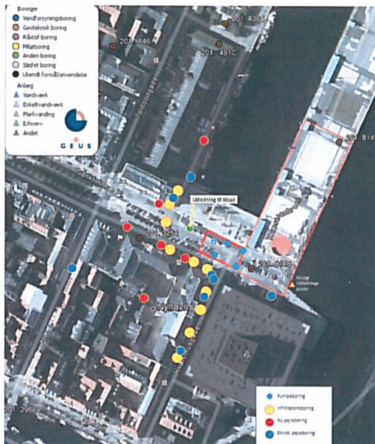
Figur 3-1 Boringer der indgår i grundvandskontrolanlægget for Vestcellen. Boringerne inde i byggegruben omfatter 2 pumpeboringer og 2 aflastningsboringer/grædeboringer
